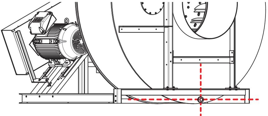
Fig. 30: Position correcte de l'écoulement de condensat
