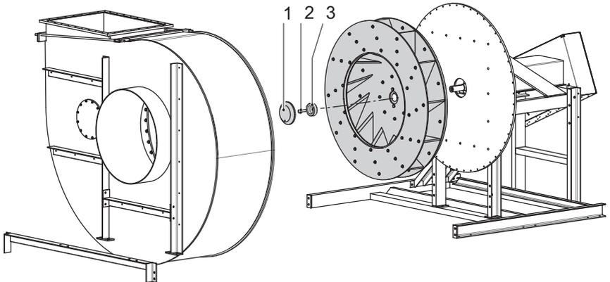
Fig. 39: Remplacement de la roue du ventilateur
