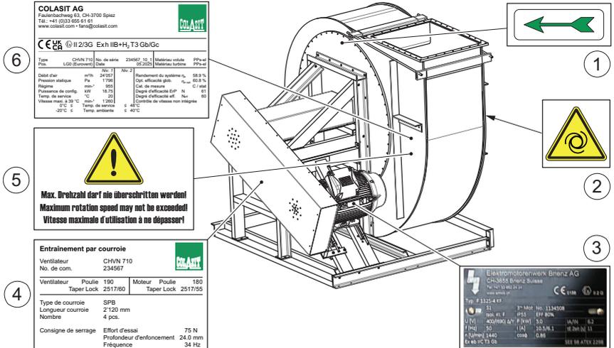
Fig. 3: Plaques et symboles d'avertissement sur le ventilateur
