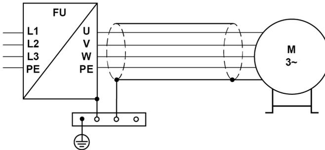
Fig. 34: Principe de raccordement pour le câble court du moteur (CF proche du ventilateur)
