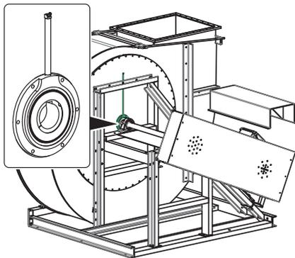
Fig. 11: Joint double avec raccord de graissage
