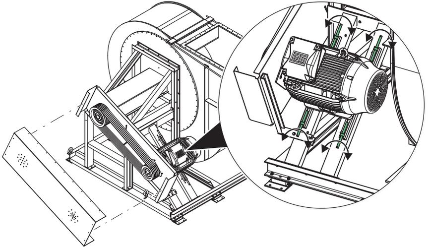
Fig. 45: Remplacez la courroie d'entraînement
