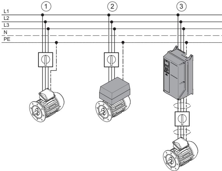
Fig. 33: Options de montage du convertisseur de fréquence
