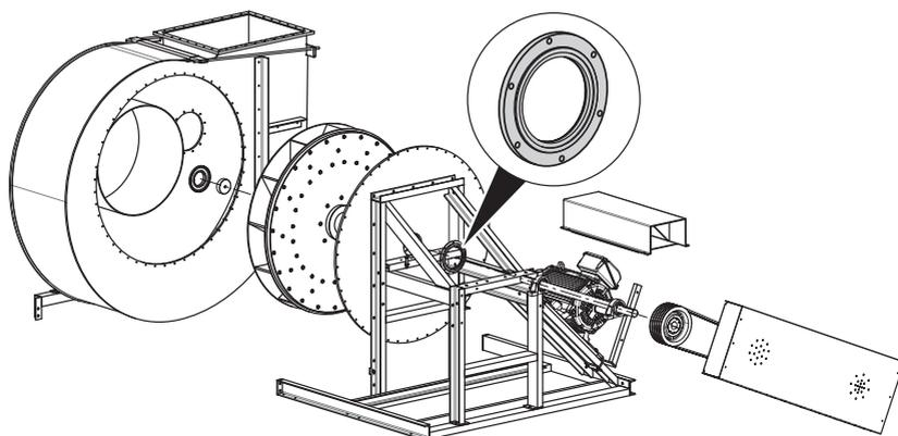
Fig. 42: Remplacer le joint à lèvres
