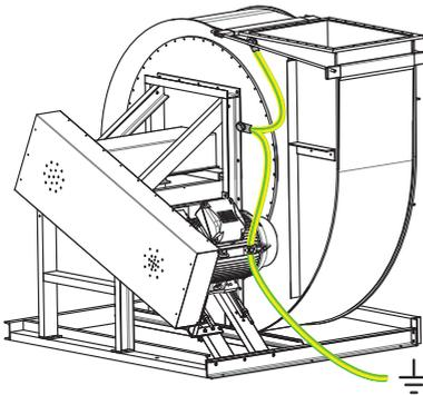
Fig. 36: Prise de terre sur le ventilateur
