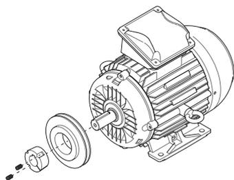
Fig. 41: Retirer la poulie de l'arbre du moteur
