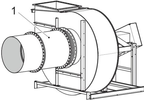
Fig. 29: Raccorder la tuyauterie à la manchette d'aspiration
