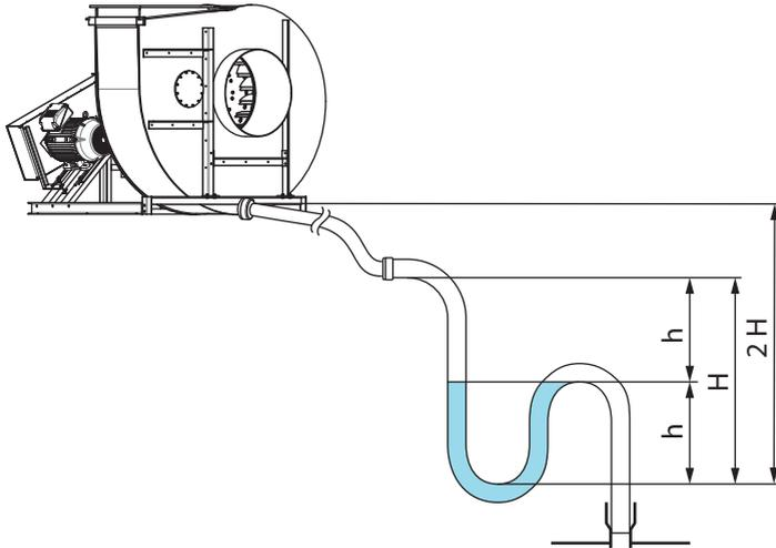
Fig. 31: Hauteur d'installation et de siphon requise
