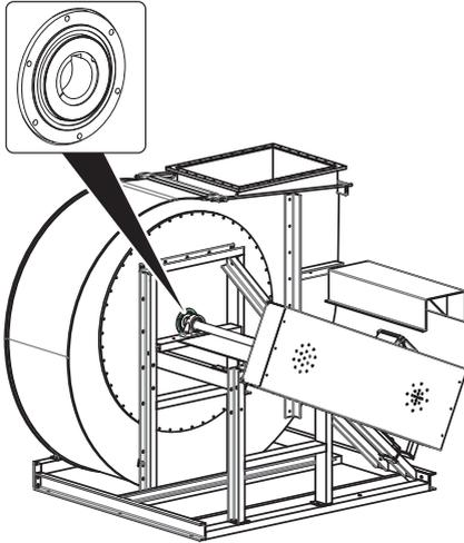
Fig. 10: Joint d'étanchéité à lèvres (simple)
