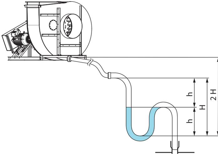
Fig. 32: Hauteur d'installation et de siphon requise
