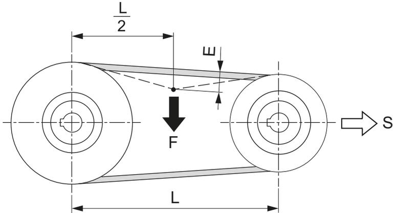
Fig. 46: Mesurez la tension de la courroie
