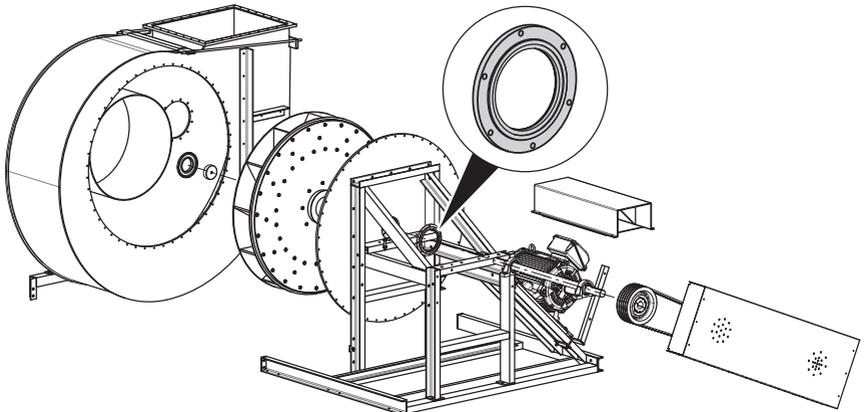
Fig. 42: Remplacer le joint à lèvres
