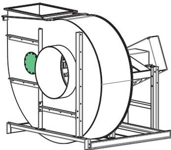
Fig. 28: Montage correct de l'ouverture de contrôle
