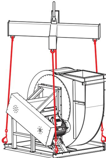
Utilisez une traverse avec 4 points d'attache pour transporter un ventilateur non emballé.
