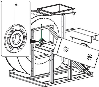
Fig. 12: Joint double avec raccord de graissage
