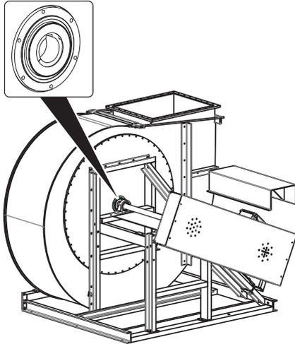
Fig. 11: Joint d'étanchéité à lèvres (simple)
