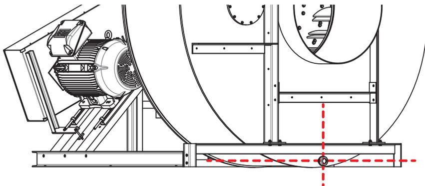
Fig. 31: Position correcte de l'écoulement de condensat
