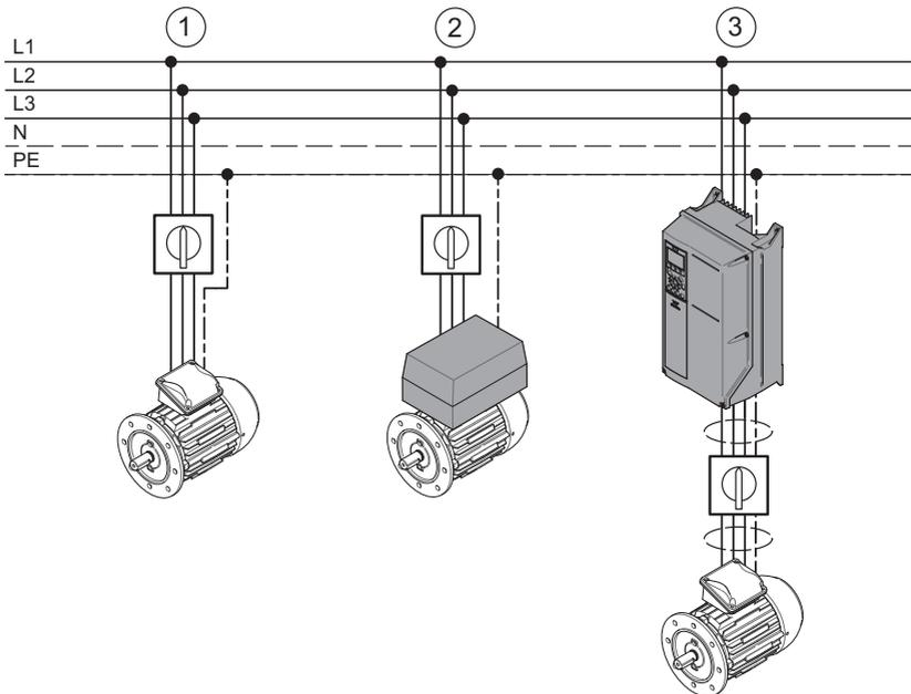
Fig. 34: Options de montage du convertisseur de fréquence
