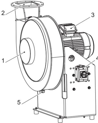
1. Manchette d'aspiration (côté aspiration): raccordement à la tuyauterie d'amenée d'air avec manchette souple.
