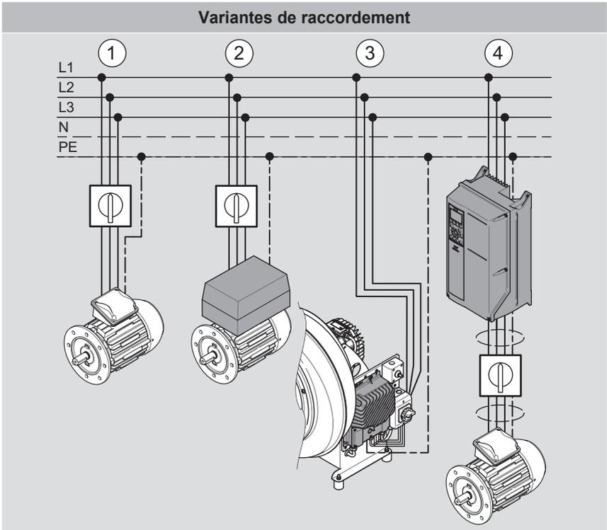
En fonction de son exécution, un moteur électrique peut être raccordé directement (1) au réseau électrique ou peut/doit fonctionner avec un CF.
