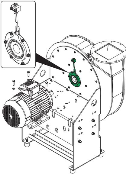
Fig. 14: Joint double avec raccord de graissage
