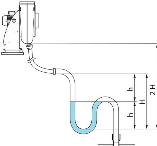
Fig. 28: Hauteur d'installation et de siphon requise
