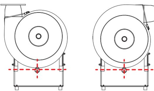
Fig. 27: Position correcte de l'écoulement de condensat
