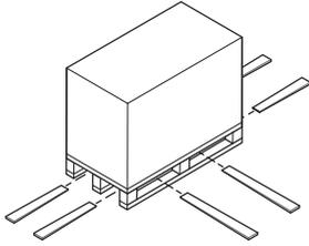
Un paquet sur une palette peut être transporté à l'aide d'un transpalette ou d'un chariot élévateur à fourche dans les conditions suivantes:
