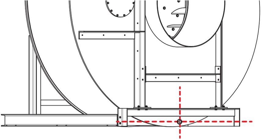
Abb. 30: Korrekte Position des Kondensatstutzens
