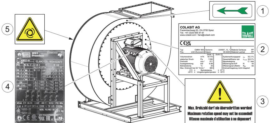
Abb. 3: Schilder und Warnsymbole am Ventilator
