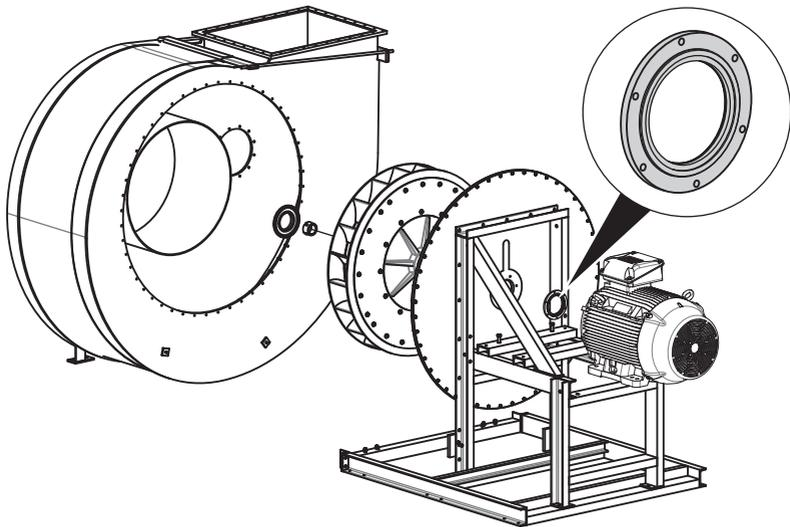
Abb. 39: Lippendichtung ersetzen
