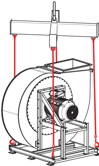
Zum Transport eines unverpackten Ventilators eine Traverse mit 4 Anhängepunkten verwenden.
