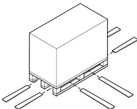
Ein Packstück auf einer Palette kann mit einem Hubwagen oder Gabelstapler unter folgenden Bedingungen transportiert werden:
