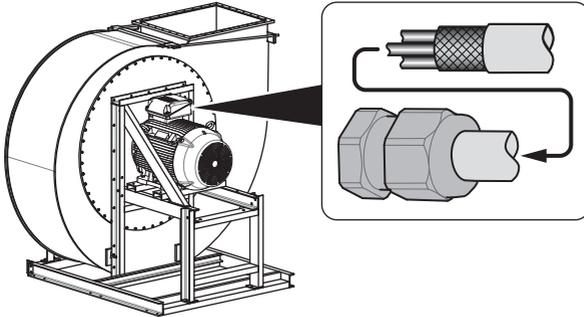
Abb. 34: EMV-Kabelverschraubung
