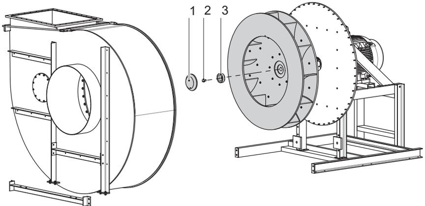
Abb. 37: Laufrad wechseln
