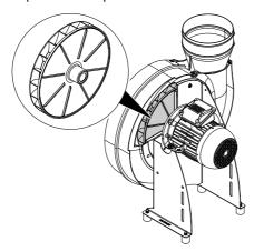
Fig. 18: Impeller back-plates
