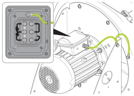
Fig. 34: Grounding cable on fan
