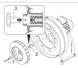
· Loosen impeller.
