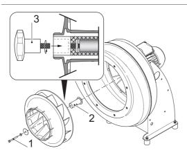
Fig. 37: Removing impeller
