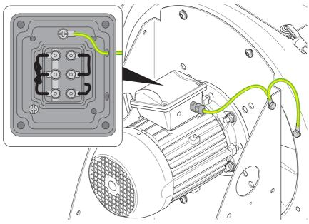
Fig. 32: Grounding cable on fan
