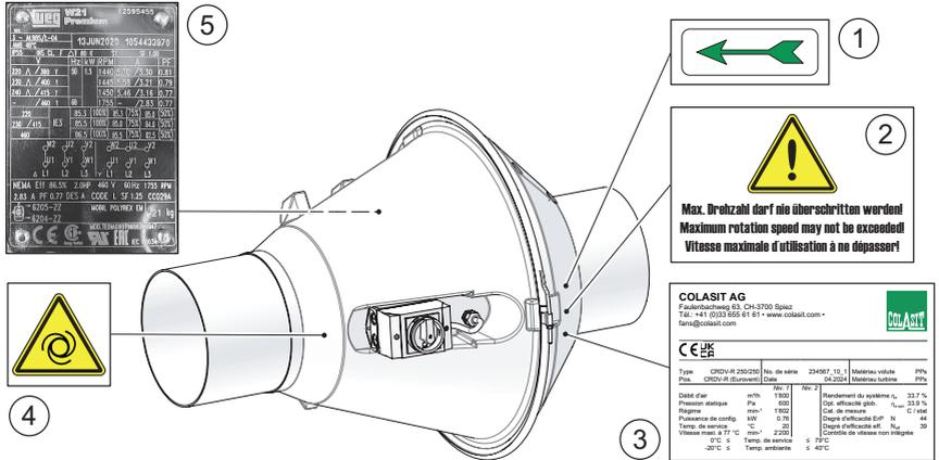
Fig. 3: Plaques et symboles d'avertissement sur le ventilateur
