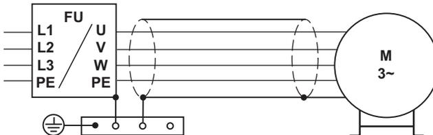
Fig. 25: Principe de raccordement pour le câble court du moteur (CF proche du ventilateur)
