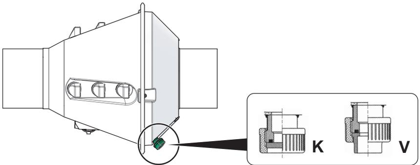
Fig. 23: Position correcte de l'écoulement de condensat
