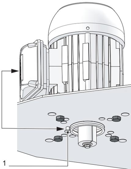
Fig. 32: Positionner le moteur électrique
