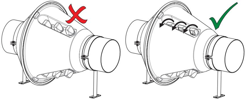
Fig. 21: Orienter la manchette d'air en cas d'installation extérieure en position horizontale
