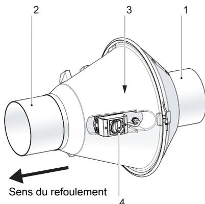
1. Manchette d'aspiration (côté aspiration): raccordement à la tuyauterie d'alimentation en air avec manchette souple.
