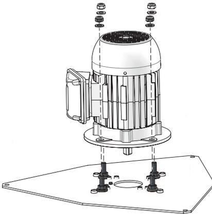
Fig. 31: Démontez le moteur électrique
