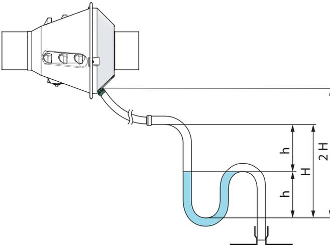
Fig. 24: Hauteur d'installation et de siphon requise
