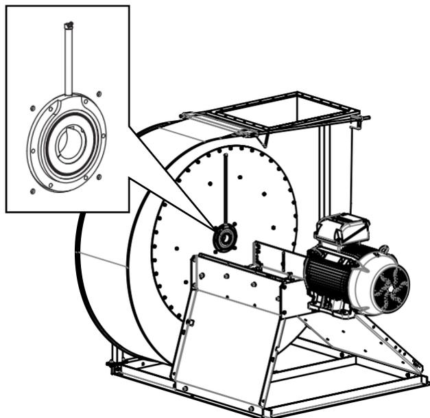
Joint double avec raccord de graissage
