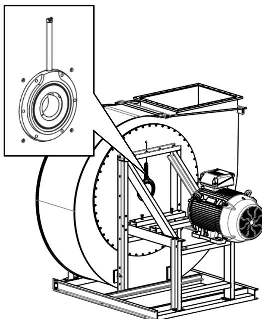
Joint double avec raccord de graissage
