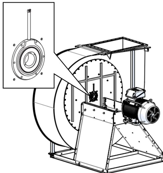
Joint double avec raccord de regraissage
