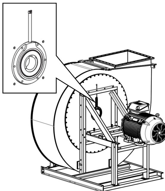
Joint double avec raccord de graissage
