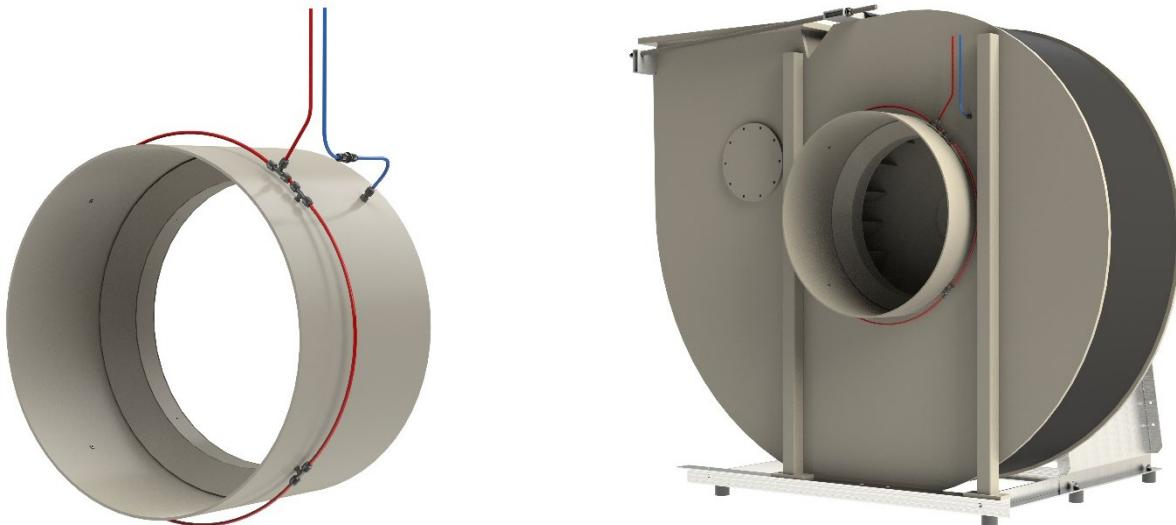
La pression différentielle  $\Delta p$  est mesurée en amont et en aval du point de mesure (rouge = surpression, bleu = dépression). La pression différentielle est en corrélation avec le débit volumétrique. Pour calculer le débit volumétrique, il faut utiliser le facteur d'étalement "k" pour le type de ventilateur concerné, ainsi que la densité du fluide dans la formule ci-dessous :
