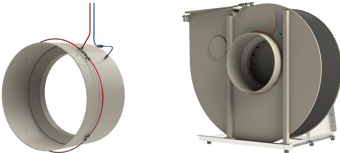
Der Differenzdruck  $\Delta p$  wird vor und an der Messstelle gemessen (rot = Überdruck, blau = Unterdruck). Der Differenzdruck korreliert mit dem Volumenstrom. Zur Berechnung des Volumenstromes wird der Kalibrierfaktor „k“ für den jeweiligen Ventilatortyp, zusammen mit der Dichte des Mediums in der untenstehenden Formel eingesetzt:
